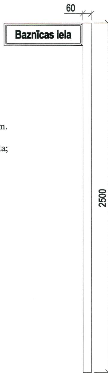
**Izmēri:** h (augstums) 2500mm, d (caurules diametrs) 60mm.
